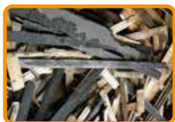
Altholz mit Bitumen- anstrich, Dachpappe
